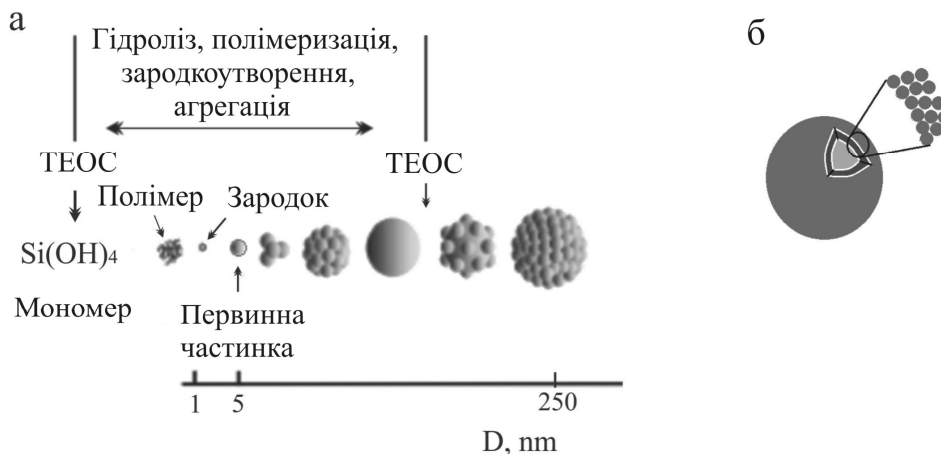
Рис. 1. а) – схема формування колоїдних мікрочастинок \text{SiO}_2 [5]; б) – схематична структура порожнистих наносфер кремнезему [1].
