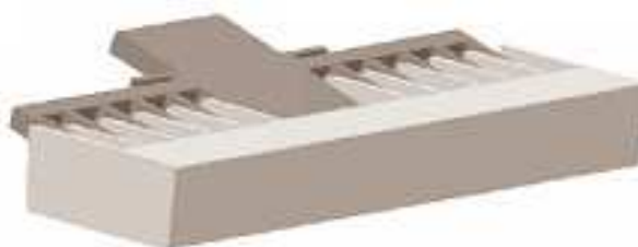
Рис. 8.20. Переміщення інтегрального мікромеханічного дзеркала під дією відхиляючої напруги
