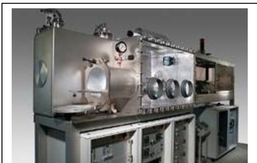
Рис. 4.1. Зовнішній вигляд установки рідиннофазної епітаксії фірми "Cyberstar" для вирощування плівок напівпровідникових твердих розчинів
