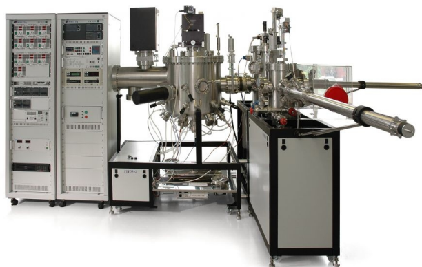
Рис. 2.14 Загальний вигляд установки для отримання плівок методом молекулярно-променевої епітаксії (STE3532)
