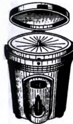
Рис. 22. Мікроцентрифуга для визначення гематокритної величини
