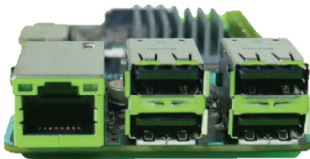
Рисунок 2.2.3.2 – Чотири порти USB 2.0 та порт Ethernet на платі Тінкер
