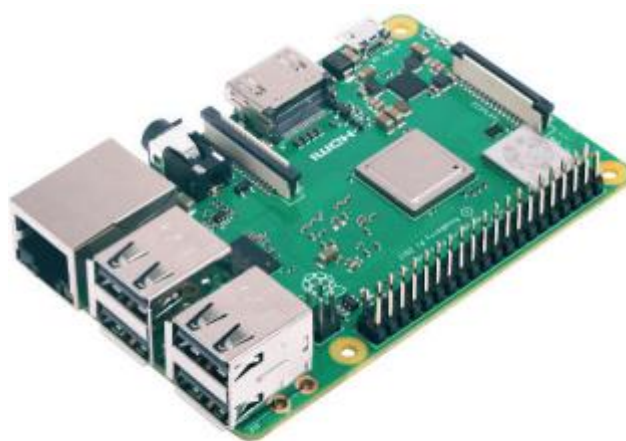
Рисунок 2.2.2.1 - РПай (модель 3В+) - це повноцінний комп'ютер у форматі кредитної картки
