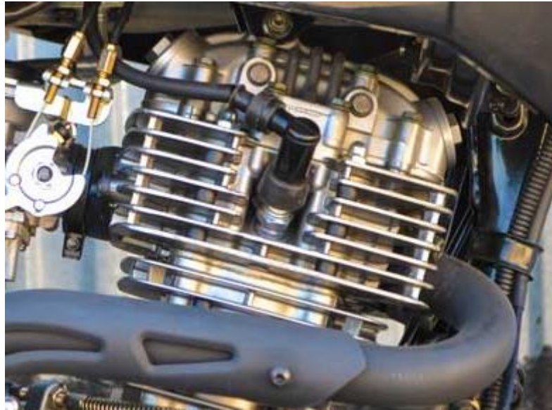
Рис. 3.4. Високовольтний провід свічки запалювання
