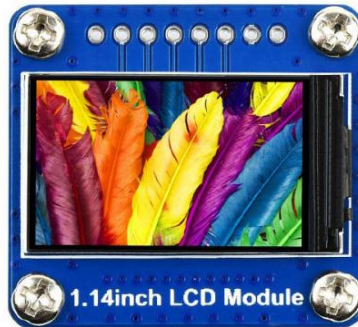
Рис. 2.18. LED модуль з IPS дисплеєм
