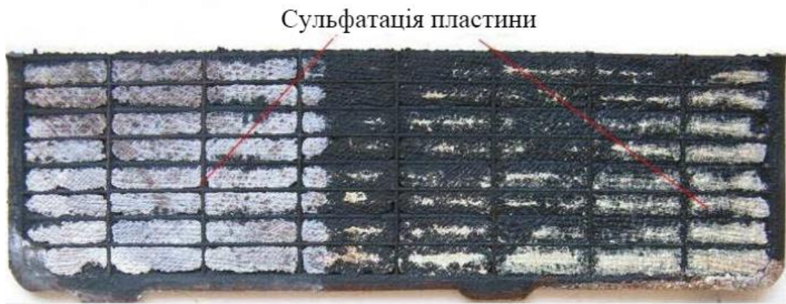
Рис. 1.3. Процес сульфатації пластини акумуляторної батареї
