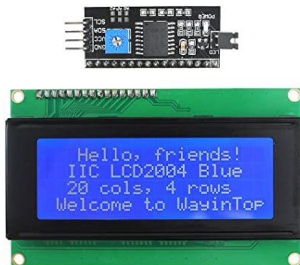
Рис. 2.19. LCD дисплей 2004A і I2C перетворювач
