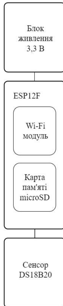
Рис.2.2 – Структурна схема системи моніторингу температури
