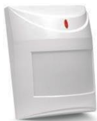
Рис1.5.Пасивний інфрачервоний сенсор руху
