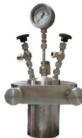
Рис. 1.9. Автоклав у якому проводився гідротермальний синтез
