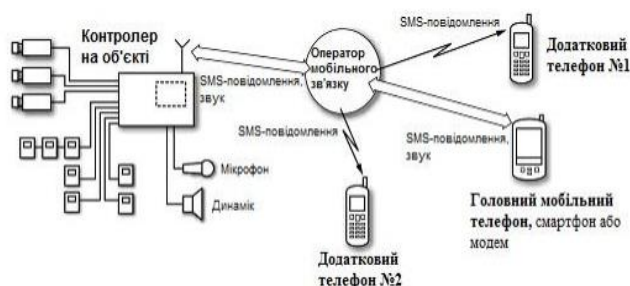
Рисунок 1 - Схема передачі інформації в GSM
