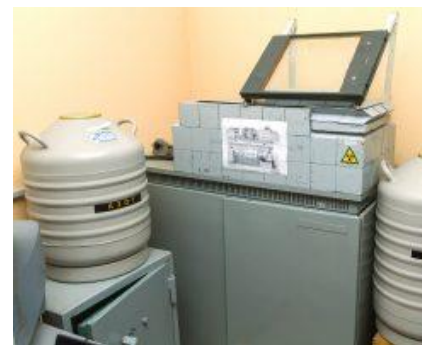
Рисунок 2.4– Месбауерівський спектрометр MS1104Em з криостатом і джерелом іонізуючого випромінювання ^{57}\text{Co} .
