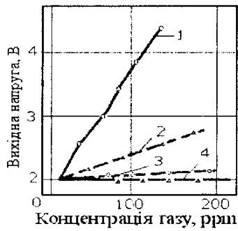
Рис. 16.27. Залежність вихідної напруги сенсора від концентрації CO (криві 1, 4) і H_2 (криві 2, 3) для нелегованих (криві 2, 4) і легованих ThO_2 (криві 1, 3) взірців при температурі 470 K; вміст кремнезему 15,4 ваг.%, величина R_p=411,5 кОм.
