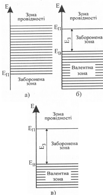
Рис. 1.3. Енергетичні зонні діаграми при температурі T = 0 К: а - металу; б – напівпровідника; в – діелектрика.
