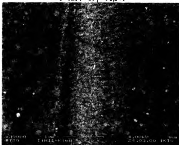
Отриманий за оптимізованим режимом спікання з контрольованою швидкістю ущільнення TiN T=1200^{\circ}\text{C} , \gamma=98,4\%
