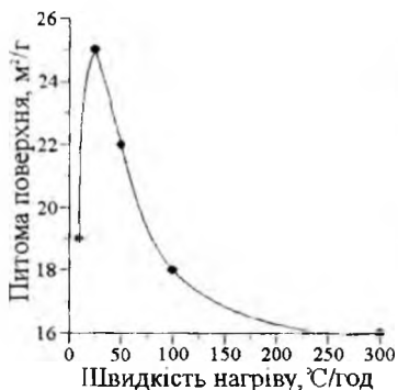
Рис. 4. Залежність питомої поверхні титанату барію від швидкості нагріву
