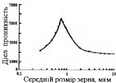
Рис. 1. Залежність ємності багатошарового конденсатора від діелектричної проникності та товщини діелектричного шару Рис. 2. Залежність діелектричної проникності при кімнатній температурі від розміру зерна (за даними Арлта)
