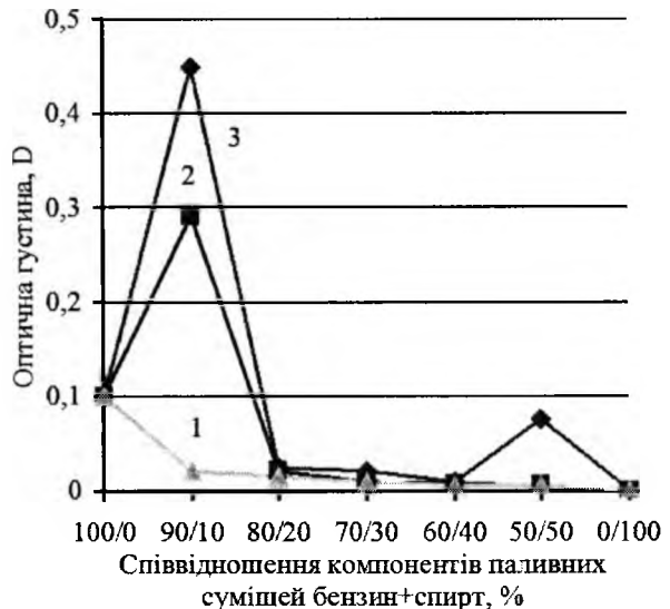
Рис. 4. Залежність оптичної густини паливної суміші від співвідношення бензини і спирту: 1 – 100 %-вий етиловий спирт (мас.); 2 – 96 %-вий спирт (мас.); 3 – 90 %-вий етиловий спирт.
