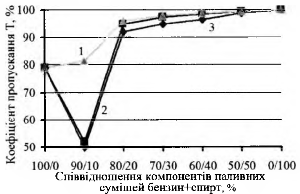
Рис. 3. Залежність коефіцієнта пропускання (Т) паливної суміші від співвідношення бензини і спирту: 1 – 100 %-вий етиловий спирт (мас.); 2 – 96 %-вий спирт (мас.); 3 – 90 %-вий етиловий спирт.
