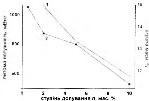
Рис. 57. Взаємозв'язок між питомою потужністю ЛДС із катодами на основі матеріалів TiO_2/nFe_2O_3 (крива 1) та втратою маси катодного матеріалу при нагріванні до 1000^\circ\text{C} (крива 2)
