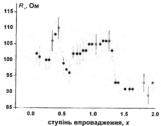
Рис. 46. Зміни опору електроліту R_1 у процесі розряду джерела з катодом на основі \text{TiO}_2/20 \text{ мас.}\% \text{ Fe}_2\text{O}_3
