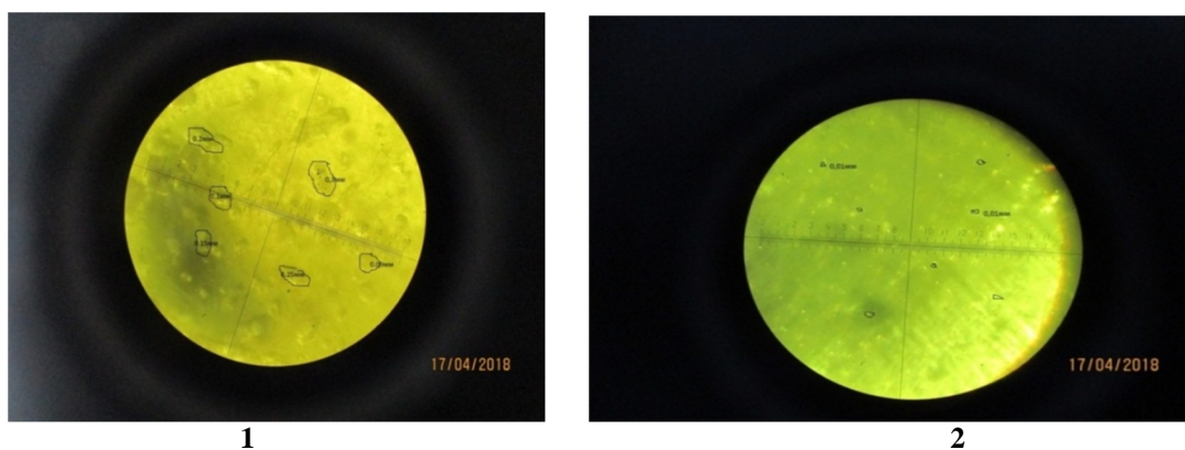
Рис. 10. (1,2). Пилко у натуральному меді - 1, ( D -частинки пилку = 0,05 - 0,1 мм) і карамелізованому меді - 2, ( D -частинки пилку=0,01-0,01 мм), (термообробка при T = 60-75^{\circ}\text{C} ., \tau = 45-90 сек. + каталізатор), мікроскоп МБС-20 ( \times 56 раз).
