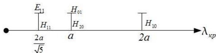
Рис. 6. Діаграма типів електромагнітних хвиль у прямокутному хвилеводі і при співвідношенні a/b = 2 .
