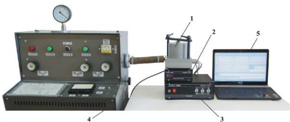
Рис. 13. Установка для вимірювання властивостей термоелектричних матеріалів [29].
