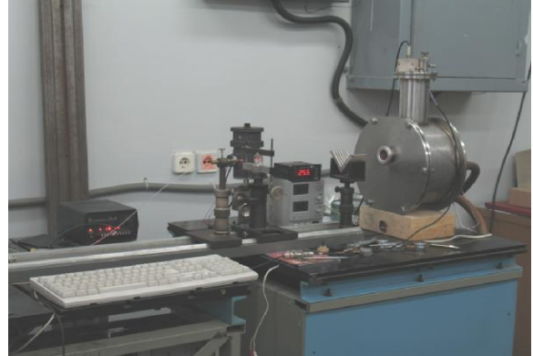
Рис. 32. Загальний вигляд установки лазерного флеш-методу для вимірювання теплопровідності тонких півок [62,65].
