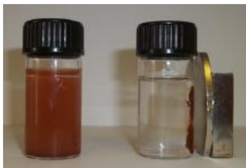
Рис. 6. Фотографія магнітної сепарації \text{ZnFe}_2\text{O}_4 з водного розчину при дії постійного магніту [7].
