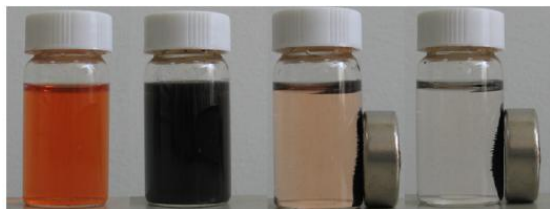
Рис. 9. Процес адсорбції Конго червоного на MFe_2O_4 в залежності від часу: розчин Конго червоного через 2 хв.; через 40 хв. [6].
