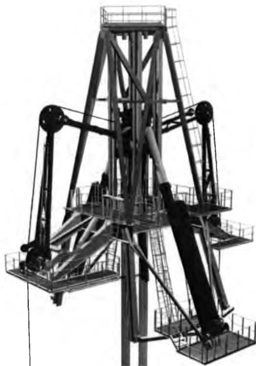
Рис. 12. Конструкція компенсатора з похилими гідроциліндрами (Aker Solutions)
