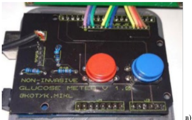
Рис. 2. Загальний вигляд а), персональна вушна кліпса б) та головний модуль в) пристрою неінвазивного контролю рівня глюкози в крові.
