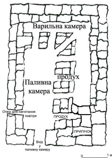
Рис. 3. Унів. План гутної печі з бічним розташуванням паливної камери. Реконструкція Р.Береста за результатами археологічних досліджень
