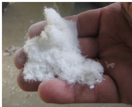
Рис. 4. Відділені на промисловій дробарці барабанного типу волокна целюлози.
