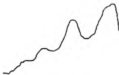
Рис.3. Прозорість алюмінієвої плівки в залежності від товщини за температури 4,2 К. Вдovж осі абсцис – товщина плівок, вдovж осі ординат – інтенсивність (у довільних одиницях) [59]
