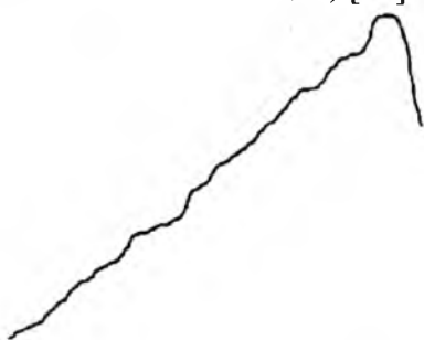
Рис.4. Прозорість алюмінієвої плівки в залежності від товщини за кімнатної температури. Вдovж осі абсцис – товщина плівок, вдovж осі ординат – інтенсивність (у довільних одиницях) [59]
