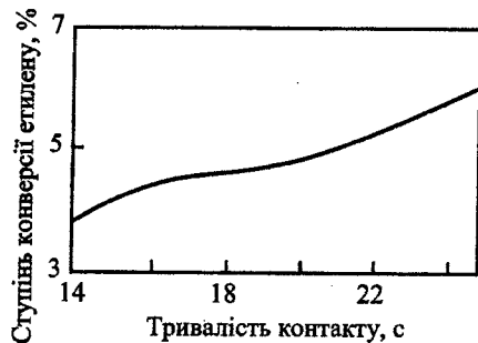
Рис. 11.9. Вплив часу контакту на ступінь конверсії C_2H_4
