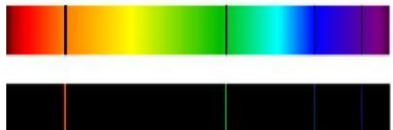
Рис. 10.16. Лінії випромінювання і лінії поглинання D -лінії (дублета) натрію.
