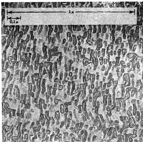
Рис. 16.39. Микрофотография поверхности образца сплава аллико-V. Структура — оптимальная для использования сплава в качестве материала для постоянных магнитов. Состав сплава аллико-V: Al (8%), Ni (14%), Co (24%), Cu (3%), Fe (51%) (проценты весовые). В качестве материала для постоянных магнитов используется двухфазная система, в которой мелкие частицы одной фазы распределены в другой фазе. Выпадение мелкой фазы происходит в магнитном поле, и поэтому частицы ориентируются так, что их продольные оси параллельны направлению поля. (Из работы Люборского.)
