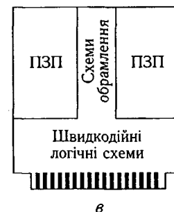
Рис. 23.13. Розміщення компонентів на друкованих платах: a — процесорна плата; б — плата інтерфейсу; в — плата ПЗП
