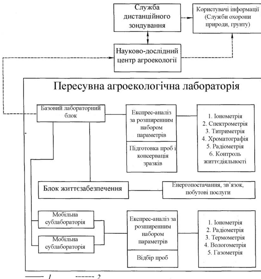
Рисунок 9.2 – Структурні елементи пересувної агроекологічної лабораторії:
