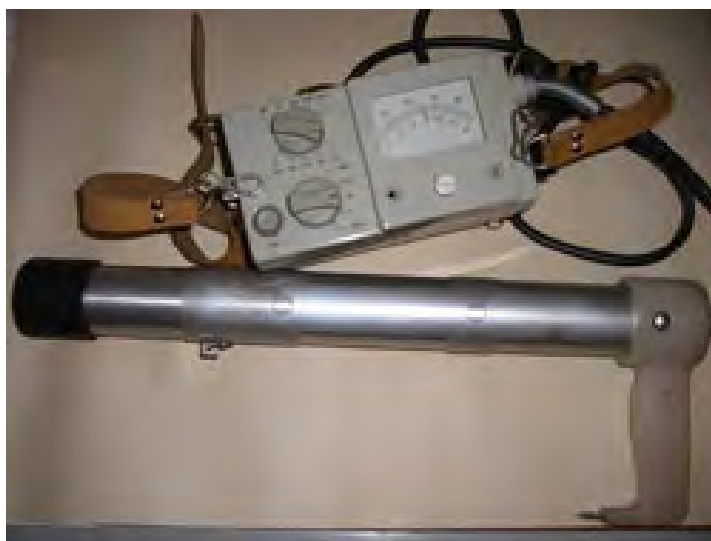
Рисунок 7.2 - Радіометр СРП-68-01
