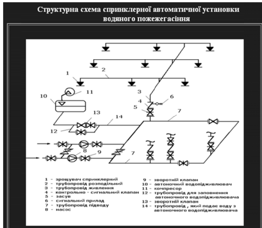
Рис. 2.3.1. Структурна схема спринклерної автоматичної установки водяного пожежегасіння
