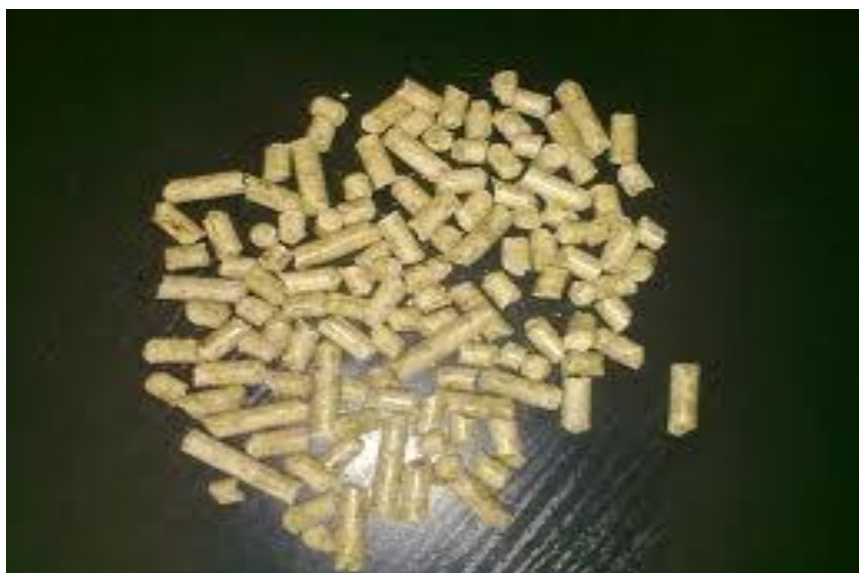
Рис. 2.5. Пелети – паливні гранули, сировиною для яких служить біомаса сільськогосподарського походження, переважно солома
