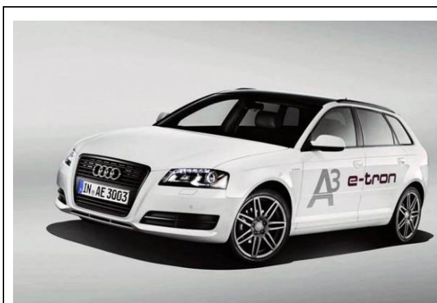
а) Електромобіль Audi A3 e-tron. Прискорення до 100 км/г досягається за 11 с. Максимальна швидкість – 140 км/год; Електродвигун – 100 кВт, потужність – 136 к.с. Проїзд без дозаправки – 145 км.
