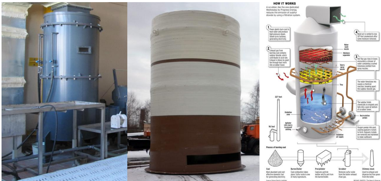
Рис. 1.19. Очищення повітря в скруберах за рахунок змочування пилю рідиною
