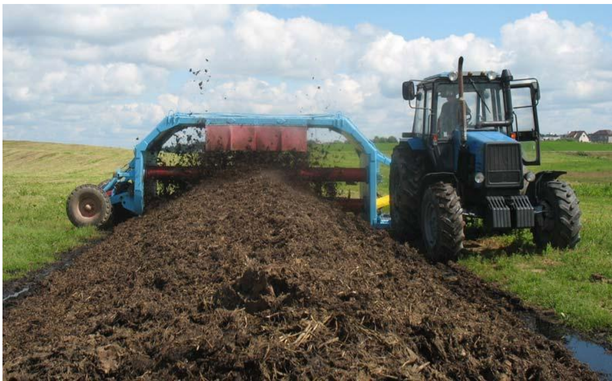
Рис. 2.2. Використання аераторів-змішувачів для перемішування компостів та насичення їх киснем
