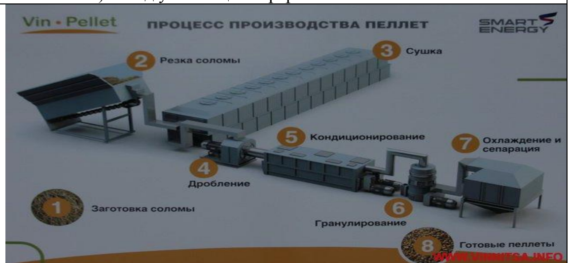
б) Етапи виробничого процесу з виготовлення пелет
