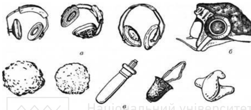
Рис. 6.6. Засоби індивідуального захисту органів слуху [13]: а – навушники; б – протишумовий шолом; в – протишумові вкладки
