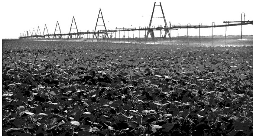
Рис. 5.10. Полив дощувальною машиною ДМ „Фрегат”
