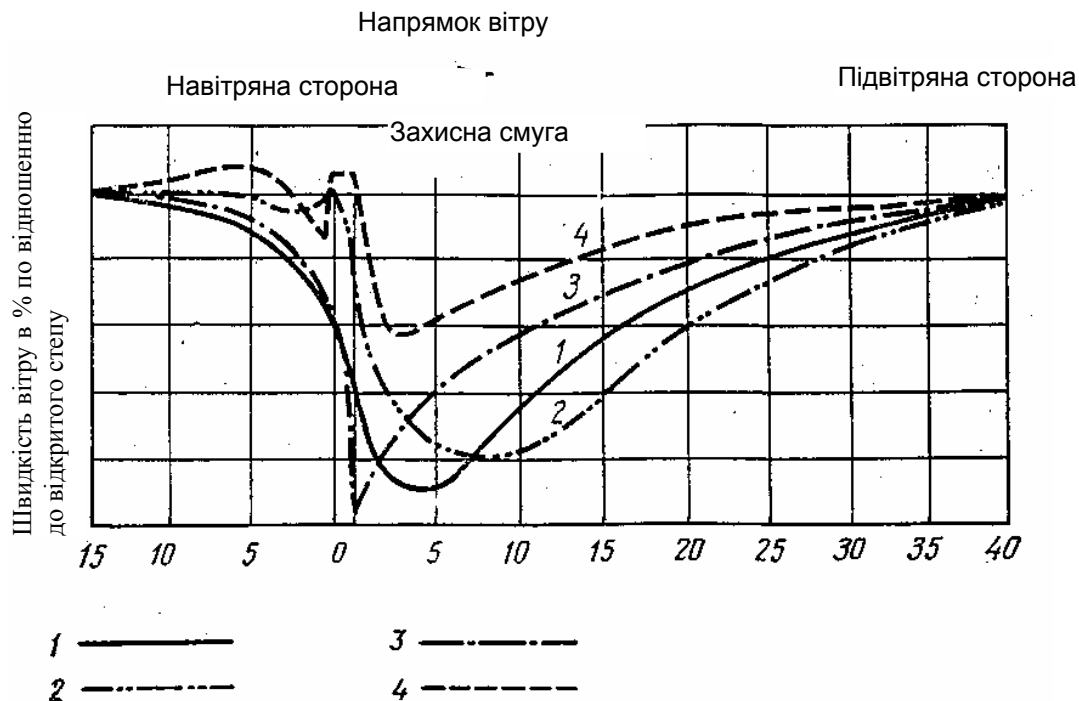
Рис. 5.13. Вплив захисних смуг різної конструкції на швидкість вітру (по Я.Д. Панфілову, 1965):
