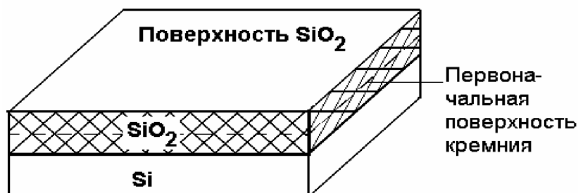
Рис. 9.1 – Рост оксида кремния
