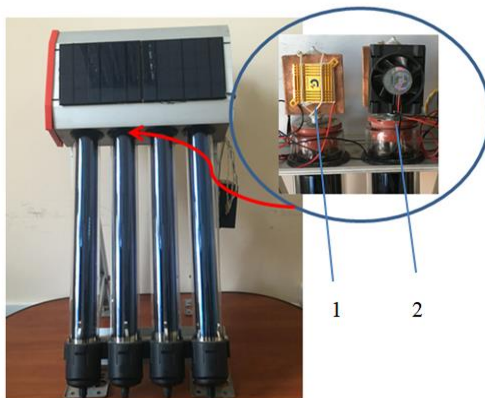
Рис. 1. Фотографія сонячного термо- електричного генератора. На вкладці зображено фото вмонтованого модуля (1) та системи охолодження (2).
