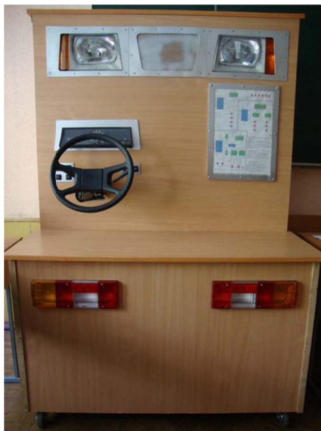
Рис. 2. Зовнішній вигляд стенду для вивчення та дослідження системи освітлення та світлової сигналізації автомобіля
