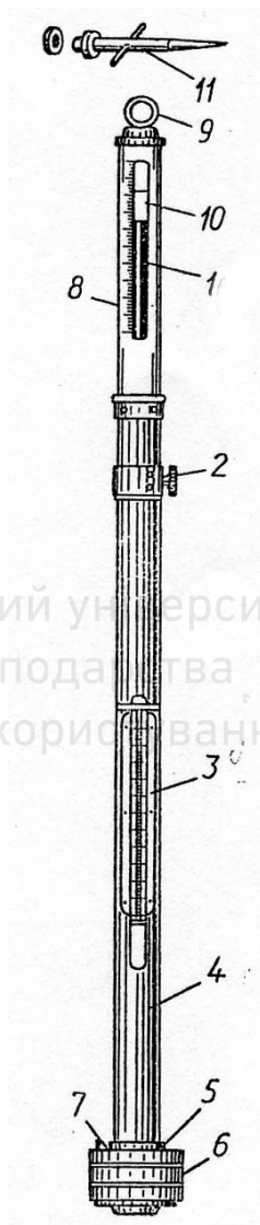
1.3. Ртутний чашковий барометр[2]
