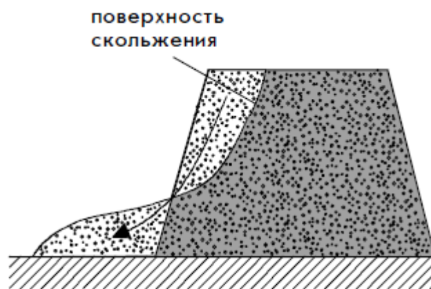
Рис. XVI.11. Деформации сдвига при откосе полотна и формирование поверхности скольжения
