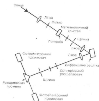
Рис. 1.7.13. Магнітометр з оптичною орієнтацією атомів
