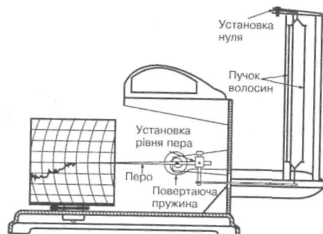
Рис. 1.5.5. Схема гігрографа
