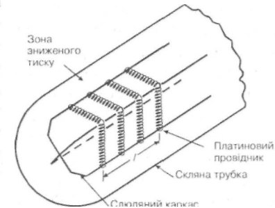
Рис. 1.6.7. Конструкція терморезистора
