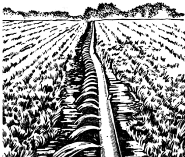
Рис. 6.6. Поливний трубопровід з водоспускними гасителями
