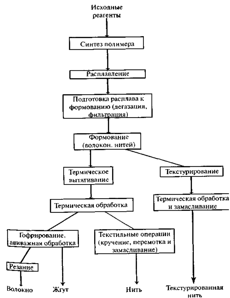
Рис. 2.1. Схема получения волокон и нитей формованием из расплавов
