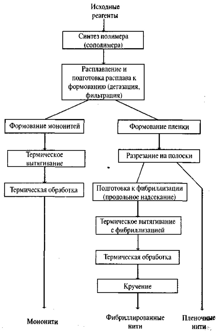
Рис. 2.2. Схема получения мононитей, пленочных и фибриллированных нитей формованием из расплавов
