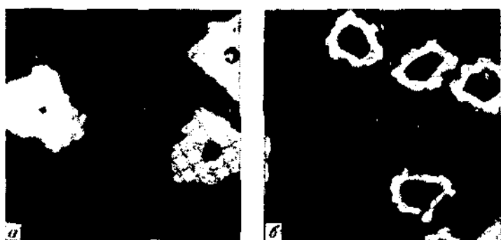
Рис. 7.7. Поперечный срез \text{B}_4\text{C} -С-волокна:
