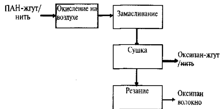
Рис. 5.2. Процесс получения окисленных полиакриловых (ПАН) волокон и нитей
