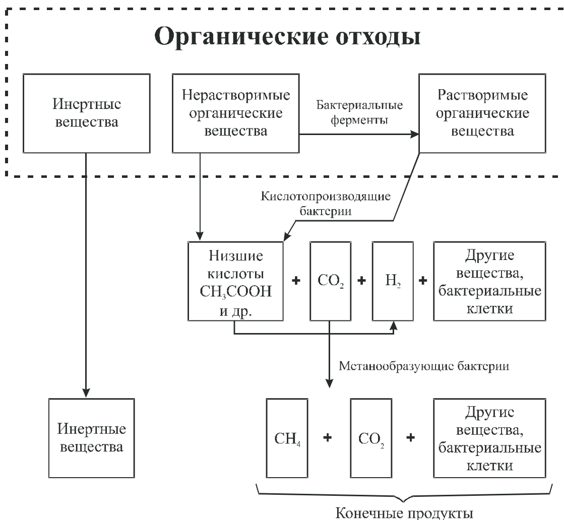
Рис. 3.4. Схема обобщенных реакций биоконверсии органических отходов
