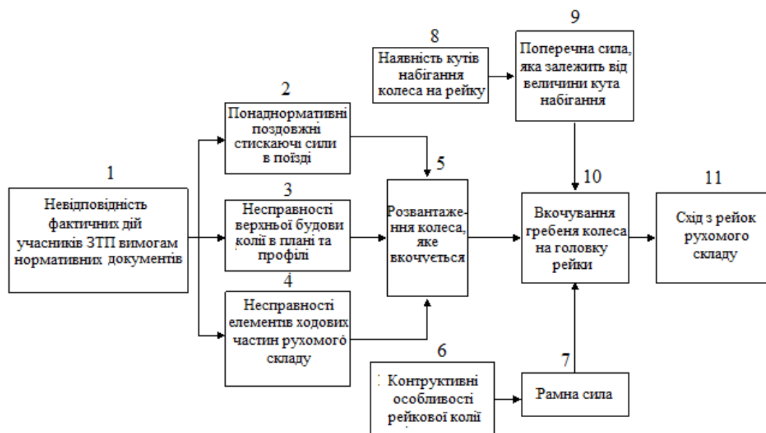
Рис. 1. Механізм залізнично-транспортної пригоди під час сходу рухомого складу у разі вкочування його колеса на головку рейки
