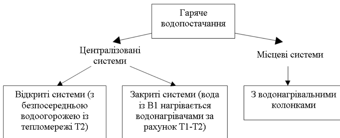
Рисунок 3.7 - Класифікація гарячого водопроводу Т3-Т4 за розташуванням джерела теплоти
