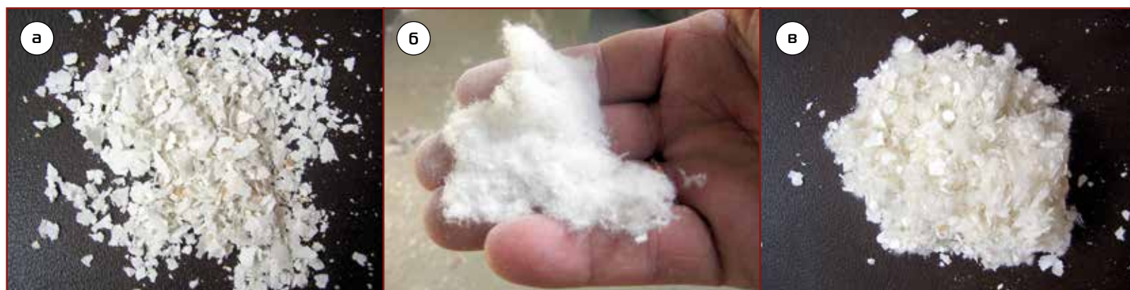
Фото 2. Неразделенные измельченные целлюлозные волокна (в) отделенного полимерного покрытия (а) и отделенные целлюлозные волокна (б), полученные при переработке отходов рулонов обоев путем сухого измельчения с фракционированием и разделением бумажной основы и полимерного покрытия на промышленных установках
