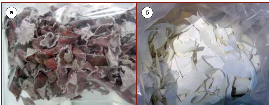
Фото 1. Частицы обоев с ПВХ-покрытием после первого измельчения в лабораторных (а) и промышленных условиях (б) на дробилках рубально-режущего типа
