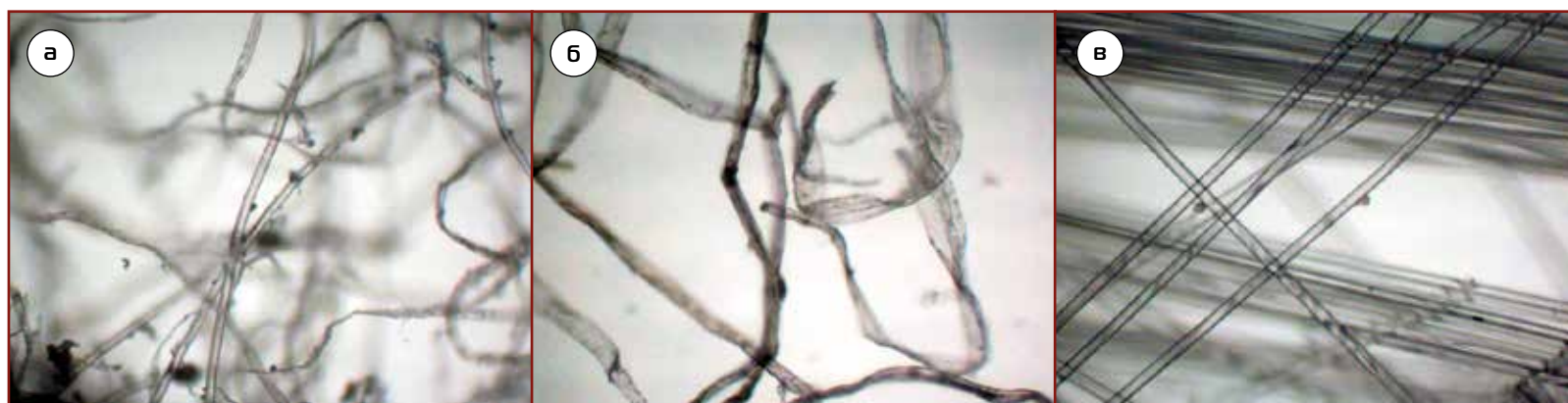
Фото 4. Микрофотографии волокон целлюлозы, полученных при измельчении отходов обоев (а), природных волокон (б) и ПВА-волокон (в), которые используются на ОАО «Ивано-Франковскцемент» для получения асбестоцементного шифера. Размер волокон целлюлозы L = 0,1\text{--}10 см, D = 0,01\text{--}0,1 мм. Фотографии сделаны с помощью микроскопа РО-3320 (с масштабом 1:100)
