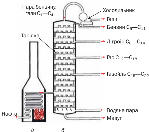
Мал. 44. Схема установки для перегонки нафти: а — трубчаста піч; б — ректи- фікаційна колона
