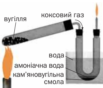
Мал. 49. Дослід із коксування вугілля
