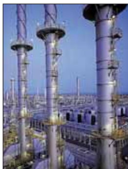
Мал. 45. Ректифікаційні колони на нафтопереробному заводі
