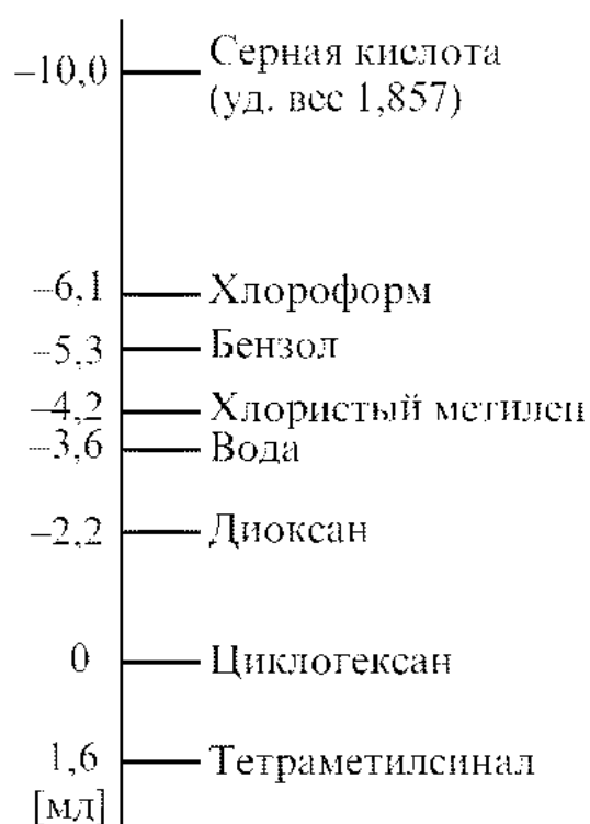
Рис. 17.8. Экспериментально определённые химические сдвиги протонных сигналов. За нуль выбрано положение сигнала для циклогексана
